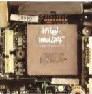
All'interno della macchina sono entrati a pulita. Nel particolare qui in alto possiamo ammirare il "cuore" (486DX4 a 100 MHz)
